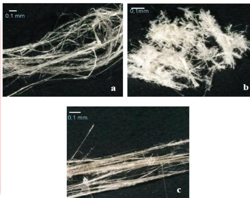
Rys. 1 Długowłóknisty azbest chryzotylowy praktycznie niezawierający zanieczyszczeń (a), chryzotylowy azbest krótkowłóknisty zanieczyszczony talkiem (b), azbest amozytowy (c) za: „Bezpieczne postępowanie z azbestem i materialami zawierającymi azbest”, Praca zbiorowa pod redakcją Jerzego Dyczka, Akademia Górniczo – Hutnicza w Krakowie, 2007
